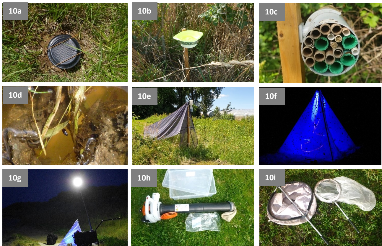
Figure 10. Dispositifs de prélèvements des arthropodes dans les IAE. 10a - Piège au sol non attractif. 10b – Cuvette jaune. 10c – Nichoir pour abeilles sauvages. 10d - Bac à lavage de bouse. 10e - Tente Malaise. 10f – Tente lumineuse ; ruban led (Duquef Y). 10g – Piège lumineux ; lampe UV (Duquef Y). 10h - Aspirateur thermique. 10i - filet entomologique - Diagnostics des infrastructures agroécologiques sur 7 exploitations en agriculture biologique, Hauts-de-France, 2022.
